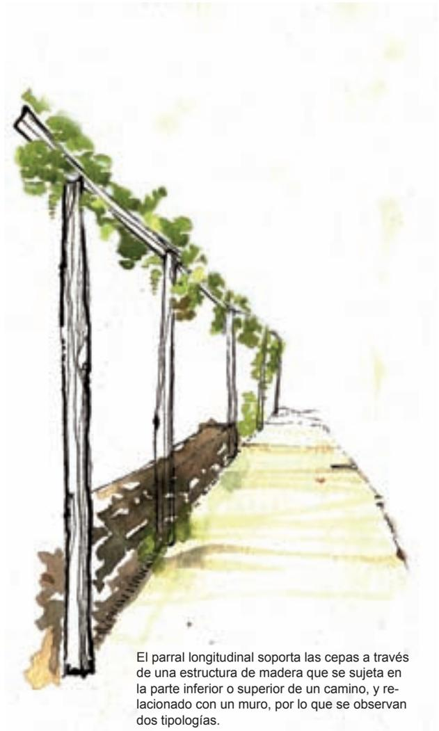
El parral longitudinal soporta las cepas a través de una estructura de madera que se sujeta en la parte inferior o superior de un camino, y relacionado con un muro, por lo que se observan dos tipologías.
